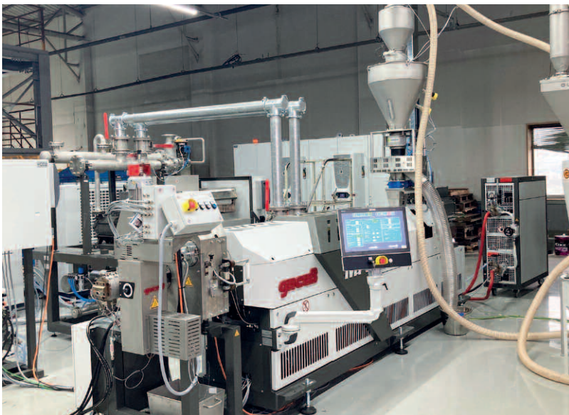
格诺斯MRS挤出系统、旋转过滤系统RSFgenius和在线粘度计VIS在KTDI实验室生产线中的应用 Gneuss MRS Extrusion System, Rotary Filtration System RSFgenius and Online viscometer VIS in KTDI lab line
