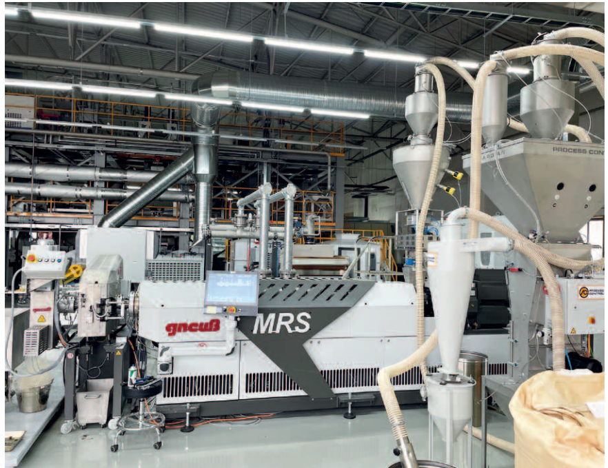
KTDI 技术中心的回收线，配备格诺斯 MRS 挤出系统、RSFgenius 旋转过滤系统，在线粘度计 VIS Recycling line at KTDI technical center with Gneuss MRS Extrusion System, Rotary Filtration System RSFgenius, Online Viscometer VIS
