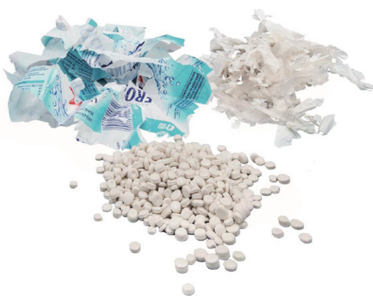
大量印刷的薄膜(左)在脱墨过程(右)后是无色的，因此可以在回收挤出机中进行处理，以制成高质量的回收颗粒(下) (图片来源:EREAMA)
