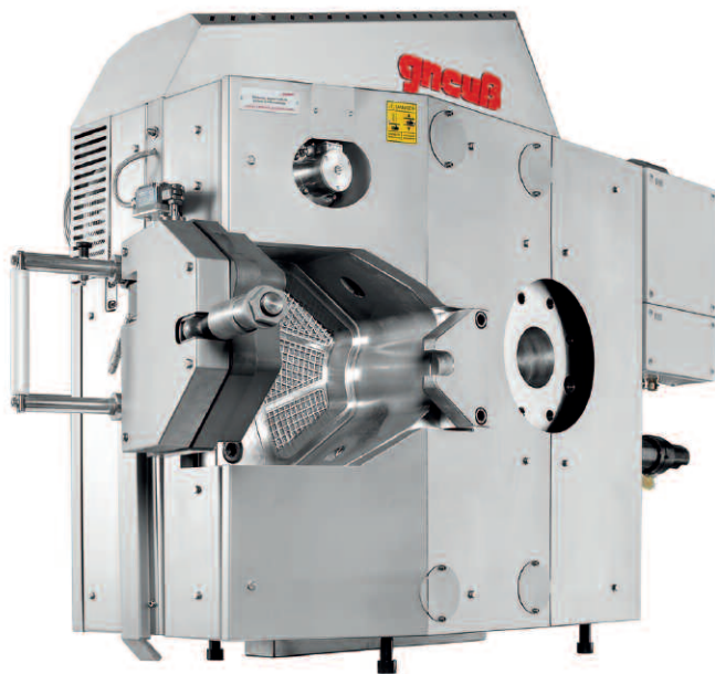
图3：专利旋转过滤系统RSFgenius
