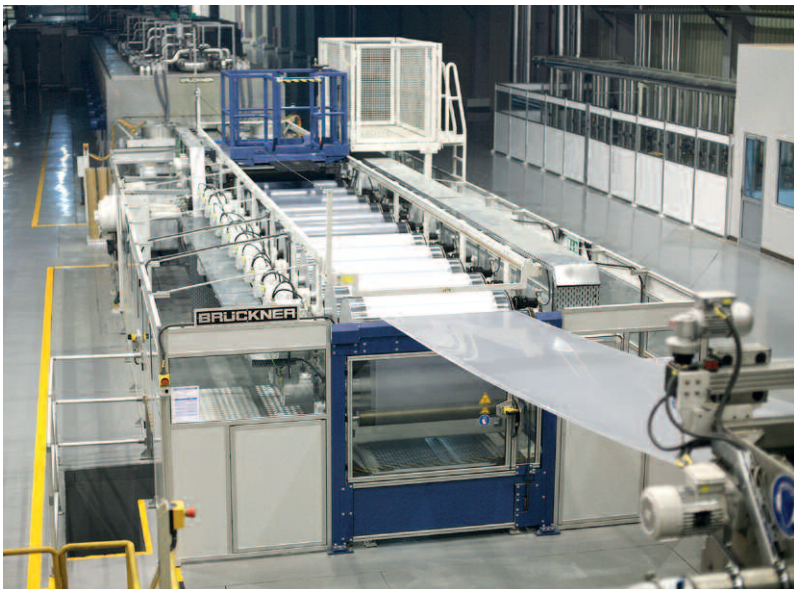
布吕克纳薄膜拉伸生产线
